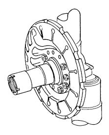
Figure 9-10. Single-Disk Brake
