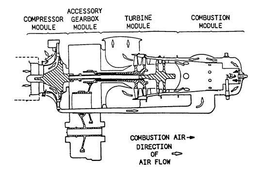
Figure 8-1. Centrifugal-Flow Engine
