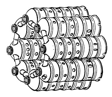
Figure 8-9. Can-Type Combustion Chamber
